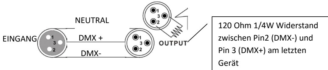
Der Endwiderstand verringert Signalfehler. Um Signalübertragungsprobleme und Störungen zu vermeiden, ist es ratsam, einen DMX Signalwiderstand zwischenzuschalten.
